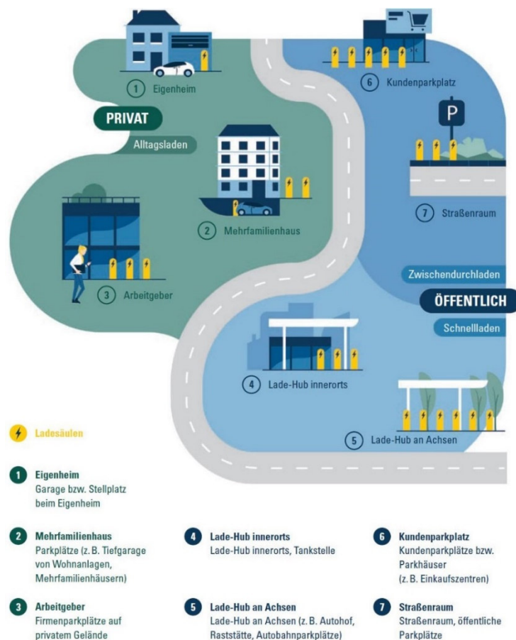
Abbildung 1–1: Definition der Lade-Use-Cases (UC) von LIS für Pkw und leichte Nutzfahrzeuge der Nationalen Leitstelle Ladeinfrastruktur (NLL 2020)
